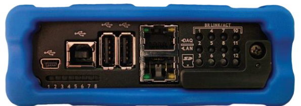
全尺寸 SD 卡插槽并带有可移除的保护盖，以支持数据记录功能
